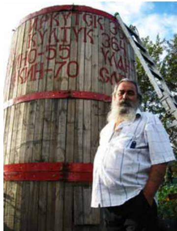
Основой чудо-бочки стали две огромные катушки из-под кабеля. Плавучесть судна обеспечивают четыреста плотно утрамбованных коробок пенопласта, а устойчивость — три тонны песка, засыпанного в нижний отсек «омулевой бочки».
