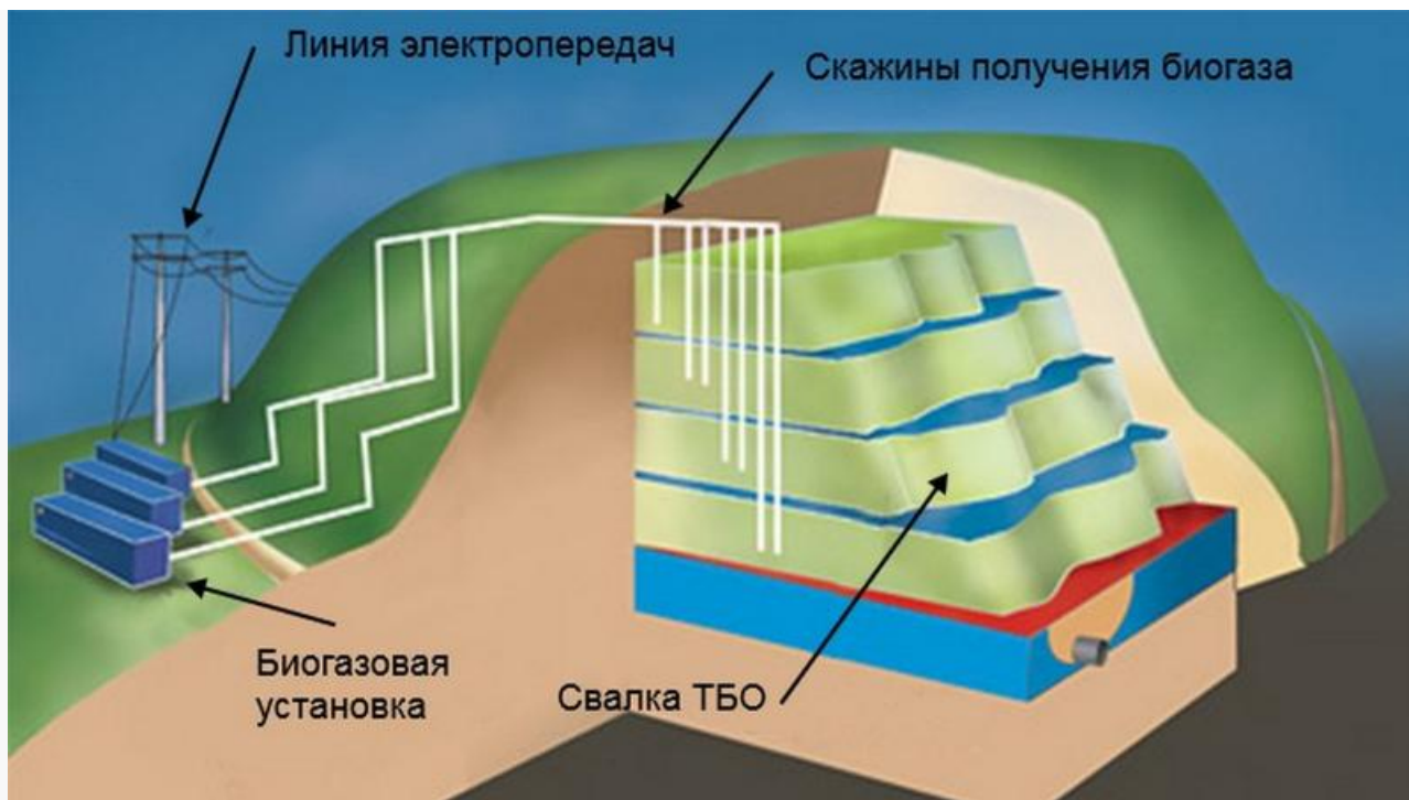
Схема утилизации свалочного газа для выработки тепловой и электрической энергии
