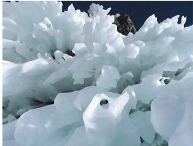
Кристаллы газовых гидратов состоят из молекул газа, впаянных в каркас из молекул воды. Фото О. Хлыстова
