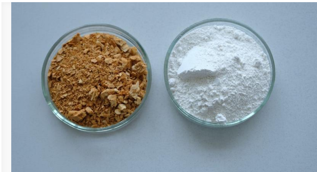
Слева на фото высушенный жир, справа – синтезированный из него полимер.
