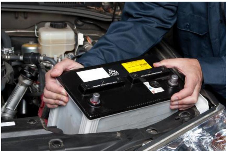
Помните, сперва нужно подсоединять «плюсы», а затем - «минусы». Снимаются зажимы в обратной последовательности.
