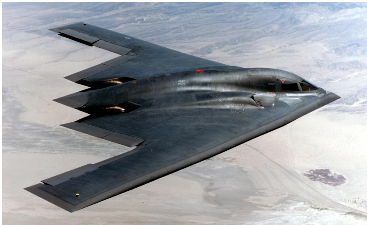
Однако таким самолетом значительно труднее управлять. Особенно на высокой скорости. Особенно при дистанционном управлении. Самолеты типа «летающие крыло» требуют наличия мощной системы электродистанционного управления, автоматически поддерживающей прямолинейный полет. В России подобных работающих систем.
