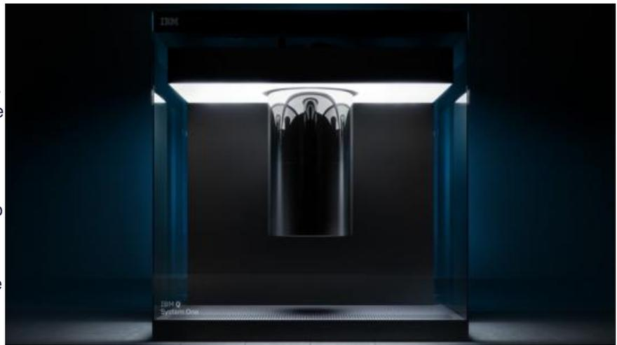
На выставке CES-2019 первый работающий квантовый компьютер представила компания IBM. Это 20-кубитная система, которая объединяет квантовые и классические вычислительные компоненты. Размеры системы достаточно велики, но это действующая модель. Инженеры компании пытаются запустить свою модель в условиях комнатной температуры без усиленного охлаждения.
