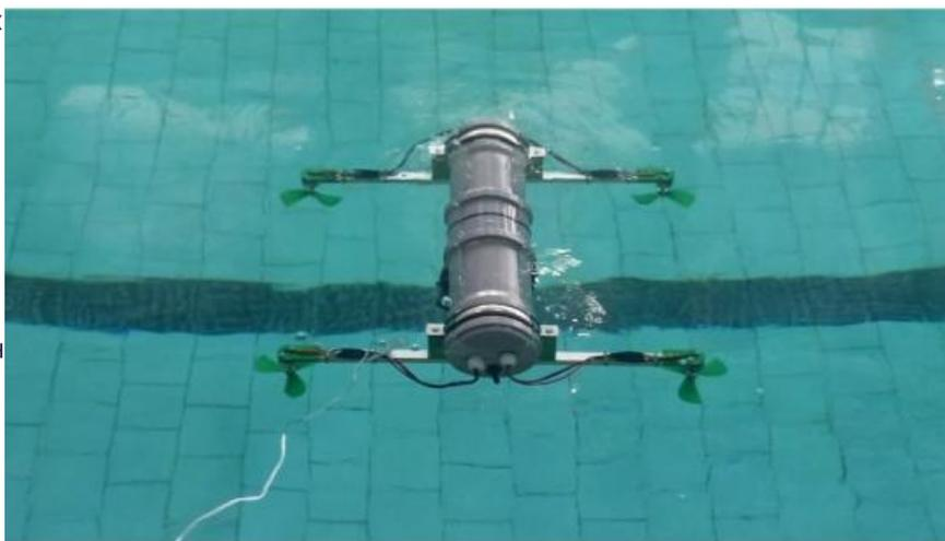
Исследования показали, что прототип погружается на глубину до метра, умеет зависать над объектом, поворачиваться и всплывать. Разработки продолжаются, и следующие модификации будут отбирать пробы воды и грунта.
