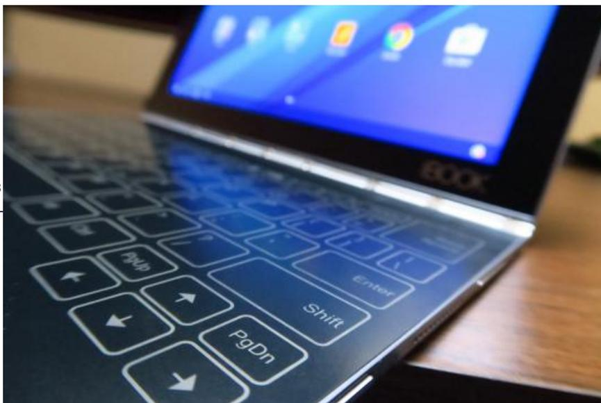
Ноутбук выпускается как на ОС Android, так и на Windows 10. Внутри у него - высокопроизводительный чипсет Intel Atom x5. Батареи емкостью 8500 мАч, по заверениям производителя, должно хватить на 13 часов работы.
