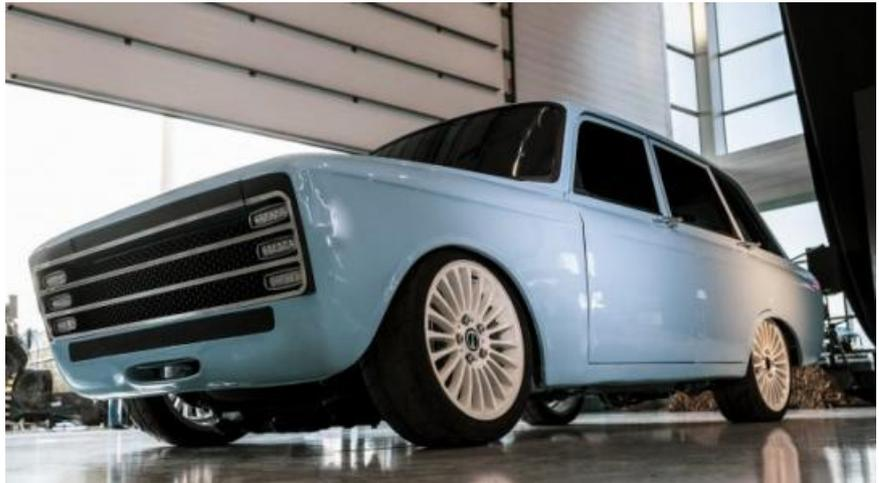
Технические характеристики новинки таковы: емкость батареи - 90 кВт•ч, от нее питается «революционный инвертор», габариты которого составляют 50x50x100 см, и позволяет развивать мощность до 1,2 кВт. Номинальная мощность CV-1 — 220 кВт, пиковая — 500 кВт. Запас хода автомобиля составляет 350 км.
