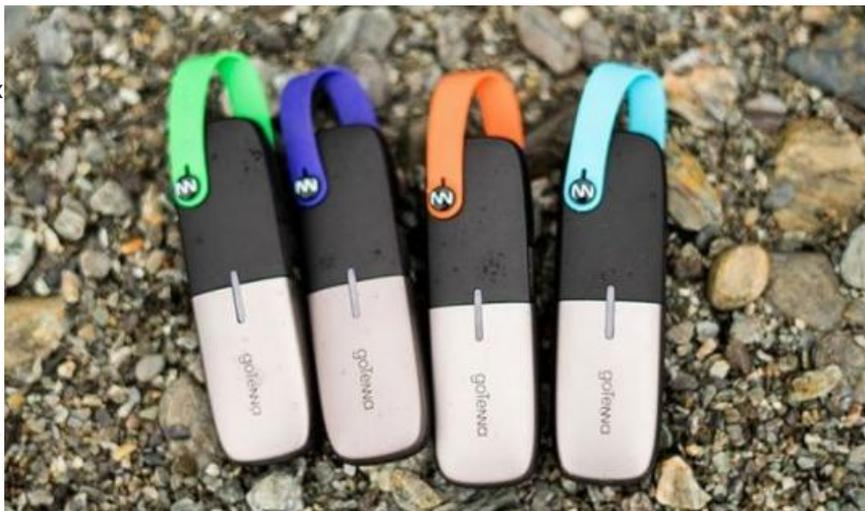
Прибор go Tenna Mesh работает на частотах УВЧ. Это на 40 % эффективнее, чем работа на частотах стандартных раций, обеспечивая надежную связь на открытой местности в радиусе до 6,5 км на открытой местности и до 800 метров - на местности со сложным рельефом. Чтобы сделать более обширную сеть, понадобится несколько приборов в нескольких точках.
