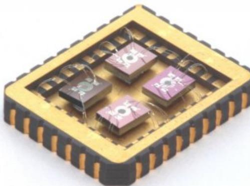
Проводимые лабораторные испытания показали, что матрица датчиков смогла зафиксировать вышеупомянутые химические вещества в концентрации три на миллиард, что беспрецедентно для портативного детектора.
