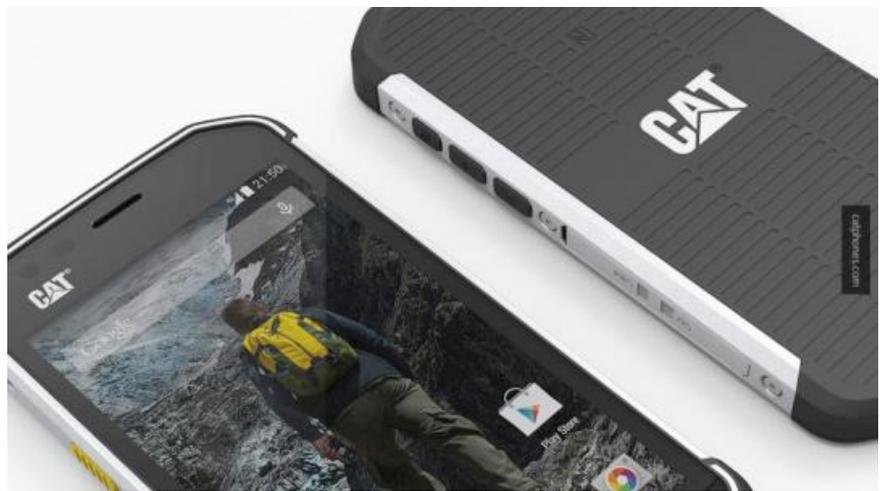
Также новинка от Caterpillar, как и другие телефоны компании, обладает противоударными свойствами и водонепроницаемостью: он спокойно проработает 1 час при погружении в воду и без последствий выдержит падение с высоты до 2 метров. Гаджет выполнен по военному сертификату прочности MIL-810G.
