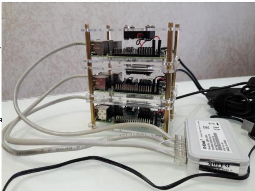
Для сборки отец с сыном нашли на интернет-аукционах крошечные платы, вентиляторы, алюминиевые радиаторы, оргстекло, сетевой кабель, болты и гайки. Сборку школьник сделал сам. Его суперкомпьютер тоже может делать сложные расчеты, к тому же производительность «машины» можно улучшать.
