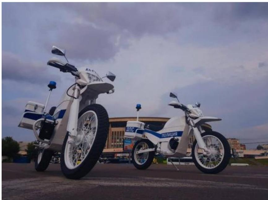
Пока из технических данных новинок известно лишь то, что максимальная мощность двигателя составляет 15 кВт, а от одной подзарядки мотоцикл сможет проехать 150 километров.
