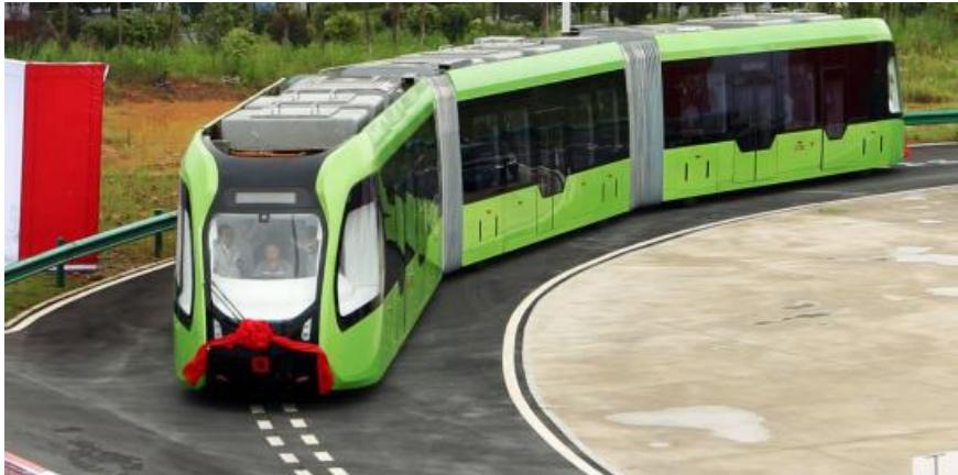
Разумеется, в свете разрабатываемых всеми беспилотных авто, китайские инженеры не стали изобретать управляемое транспортное средство. Новинка может ездить без водителя, хотя на тестовых испытаниях им для подстраховки управляет человек. Для беспилотного вождения автомобиль снабжен датчиками, которые будут сообщать о препятствиях.
