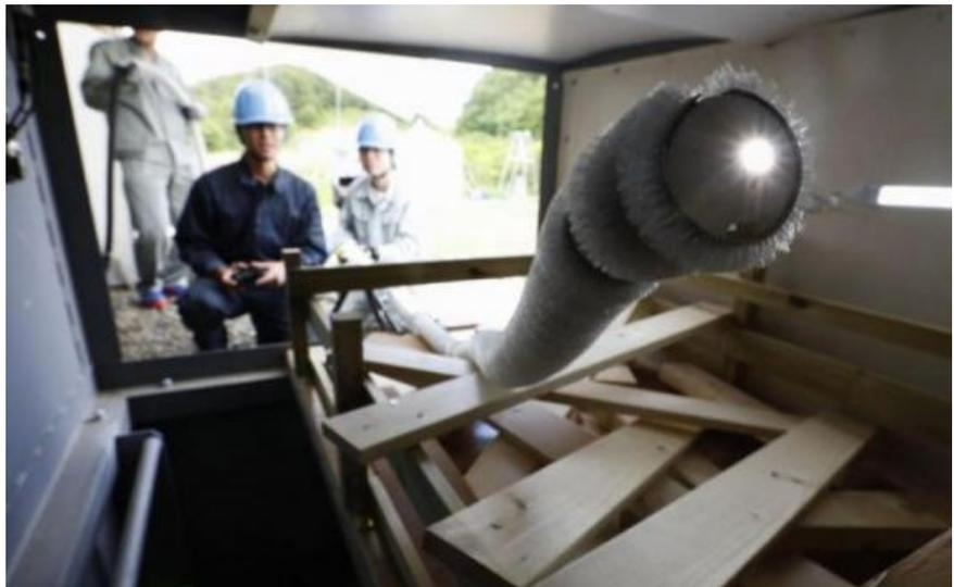
Первая модель этого робота использовалась в исследованиях атомной электростанции в японском городе Фукусима, катастрофа на которой произошла в 2011 году. Исследователи тогда не смогли научить робозмею преодолевать препятствия. Сейчас хвост устройства подтягивает «морду» к себе и таким образом приподнимает ее на 10-15 см.
