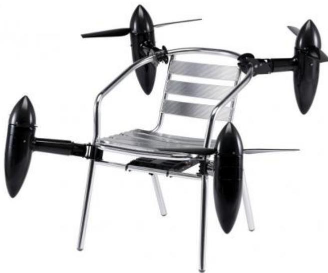
Для того, чтобы перенести груз, к нему прикрепляется 4-6 отдельных модулей с моторами и пропеллерами. И можно лететь! Пока батарей в модулях хватает только на 10 минут полета при скорости передвижения 20 км/ч. Со временем разработчики обещают увеличить время автономной работы.
