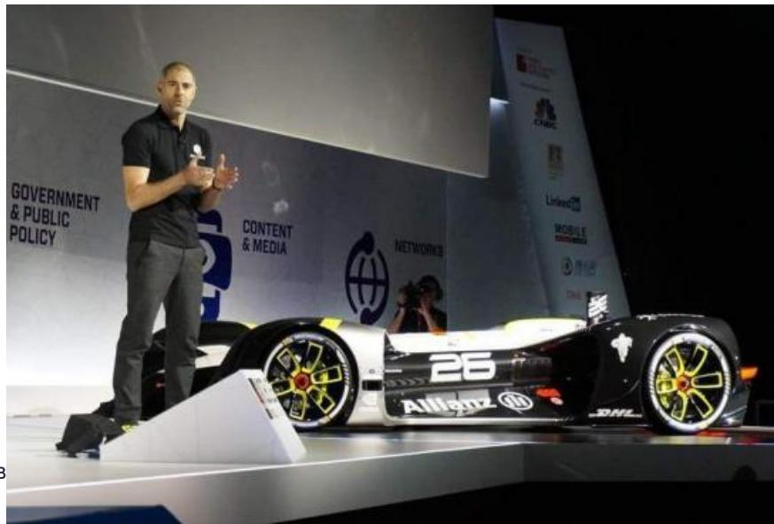
Чтобы автомобиль мог ехать без пилота, на нем установлено 18 сверхзвуковых датчиков, 2 датчика скорости, 6 камер и еще много других устройств для позиционирования в пространстве. Вычисления проводятся на процессоре Nvidia Drive PX2.
