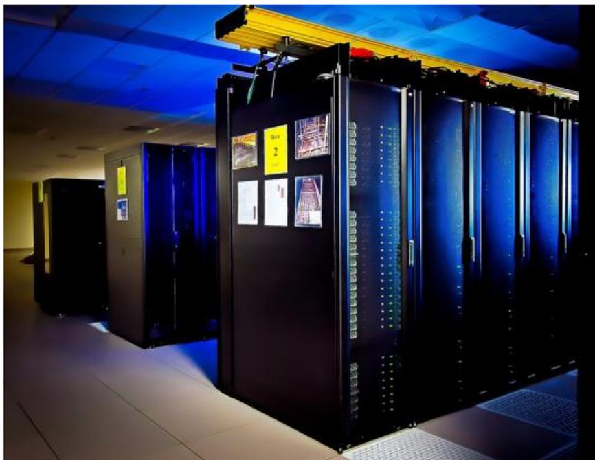
Китайский суперкомпьютер Sunway TaihuLight имеет скорость вычислений в 93 петафлопс (10 в 15 степени вычислительных операций с плавающей запятой в секунду). Sunway TaihuLight состоит из 10,65 миллиона ядер, составляющих почти 41 тысячу узлов.
