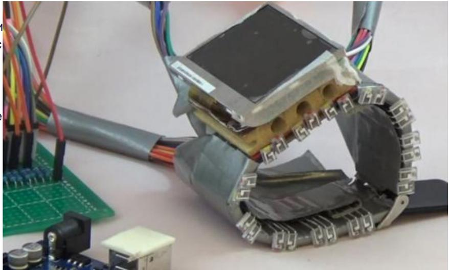
По словам создателей WristWhirl, прототип распознает жесты с довольно высокой точностью, превышающей 90%. Для этого в браслете есть 12 датчиков приближения и пьезоэлектрический датчик вибрации.
