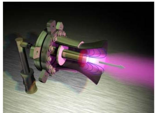
Упрощенно говоря, если в горячем плазменном двигателе газ разгоняется высокой температурой активной зоны реактора, то в холодном плазменном двигателе он разгоняется электромагнитным полем.
