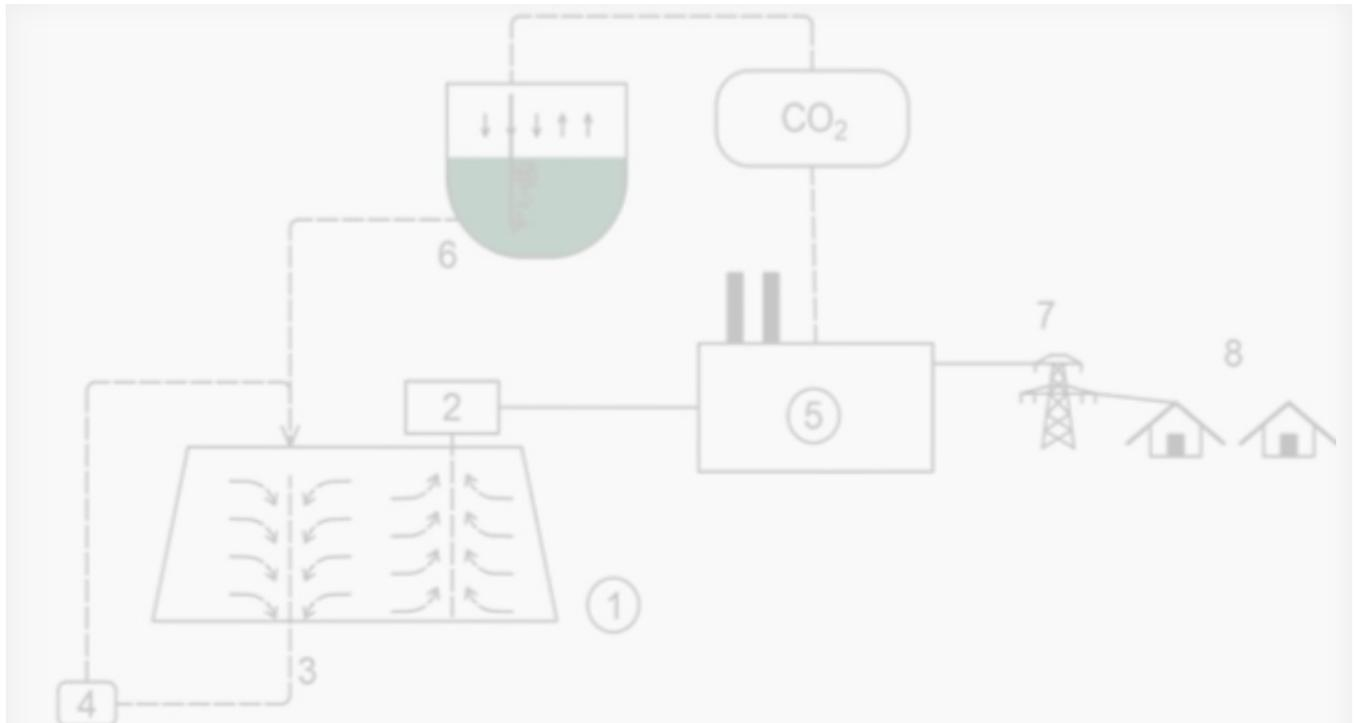
Схема орошения полигона и сбора биогаза, где 1 – полигон ТКО; 2 – система дегазации; 3 – фильтрат; 4 – система очистки фильтрата; 5 – ТЭЦ; 6 – культиваторы микроводорослей; 7 – линии электропередач; 8 – жилые дома.
