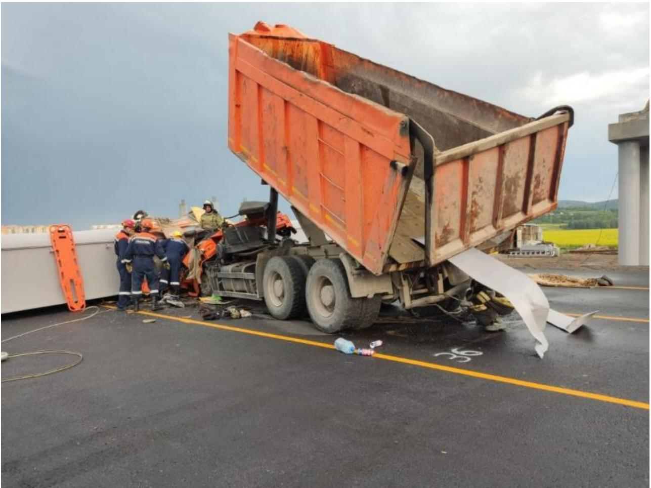
данным полиции, водитель КамАЗа после разгрузки не опустил кузов и сбил металлическую балку, которая лежала на опорах над дорогой. Балка обрушилась на кабину большегруза и раздавила ее. Водитель и пассажир скончались на месте от полученных травм.
