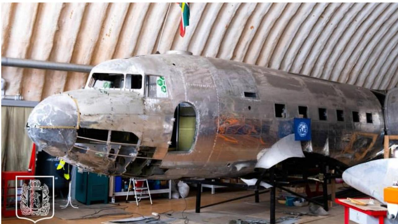
По данным правительства Красноярского края, к 21 марта восстановлены два двигателя и винты самолёта, идёт реставрация передней части фюзеляжа, которая была повреждена больше всего. Также отремонтированы узел хвостового колеса фюзеляжа, изготовлены штурвалы и частично заменена обшивка корпуса. С наступлением тепла специалисты планируют покрасить самолёт.
