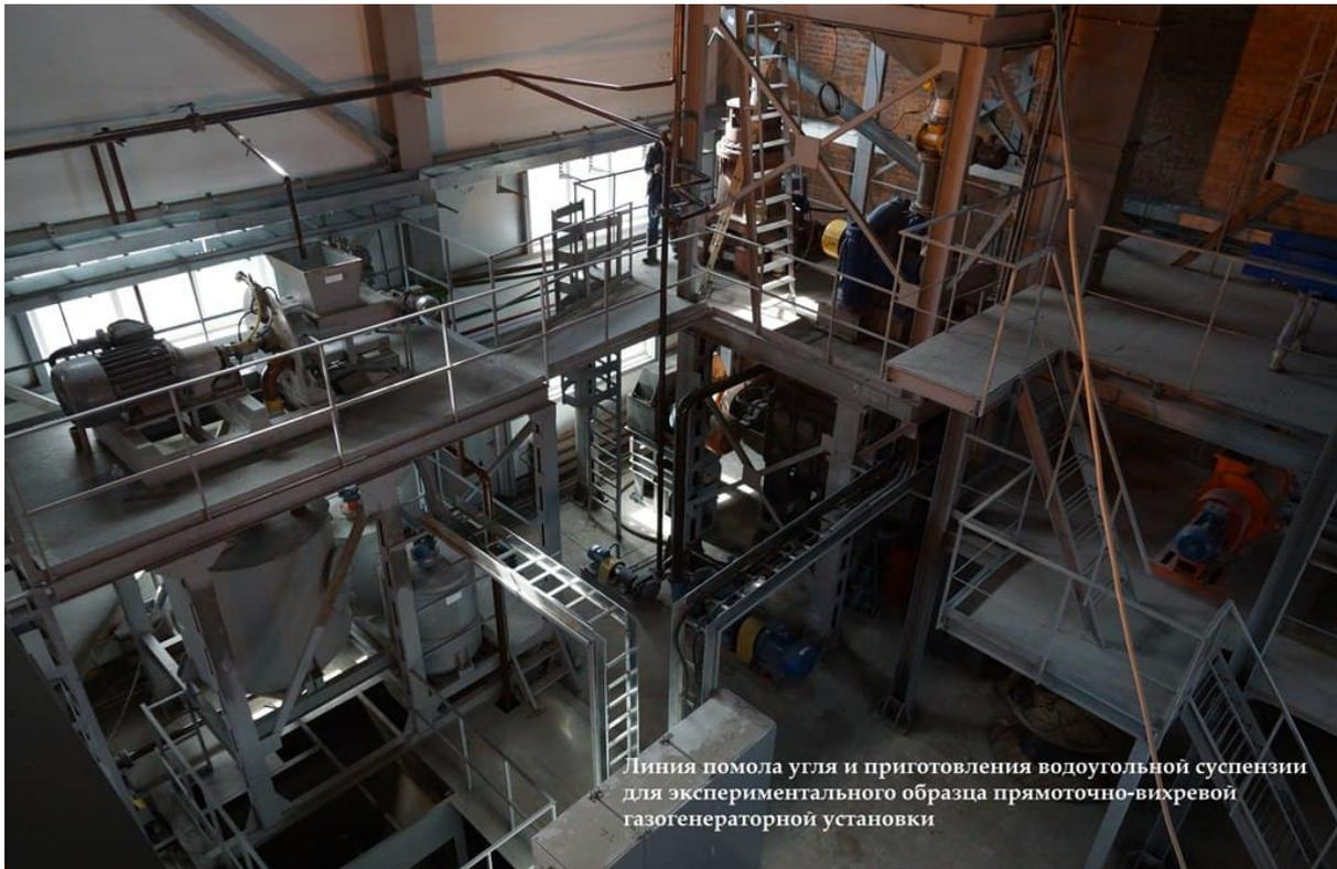
Линия помола угля и приготовления водоугольной суспензии для экспериментального образца прямоточно-вихревой газогенераторной установки
