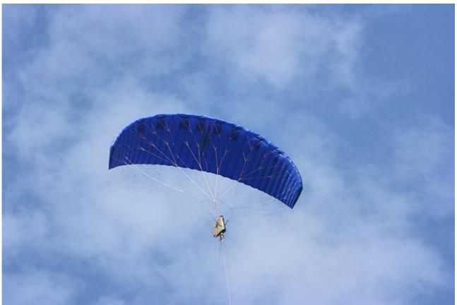
Спустя два года после испытаний ВАТ шотландский стартап Kite Power Systems при финансовой поддержке немецкого энергетического концерна E.ON, Schlumberger и нефтегазовой компании Shell сделал «воздушного змея». Конструкцию подняли на высоту 450 метров. Но технология не прижилась. При этом от нее не отказались, а решили доработать.
