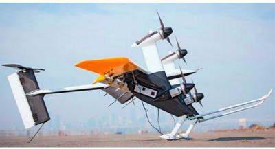
метров), а затем начинает кружиться вокруг точки привязки. Динамика полета позволяет аппарату удерживать постоянную скорость вращения турбин, из-за чего электроэнергия вырабатывается равномерно. Мощность летающего ветрогенератора - 600 киловатт.
