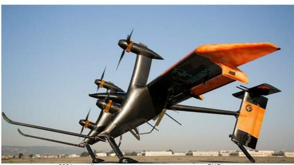
ветрогенераторов вернулись в 2021 году. Когда «зеленая» энергия и переход на ВИЭ актуальны как никогда. По факту, новым ветрякам не нужен фундамент, они работают на большой высоте, где ветер стабильнее. Летающие генераторы дешевле в производстве и обслуживании обычных ветряных турбин. Сплошные плюсы, но пока аппараты нуждаются в доработке. Не исключено, что со временем они вытеснят стационарные аналоги. Правда, на это уйдут годы.
