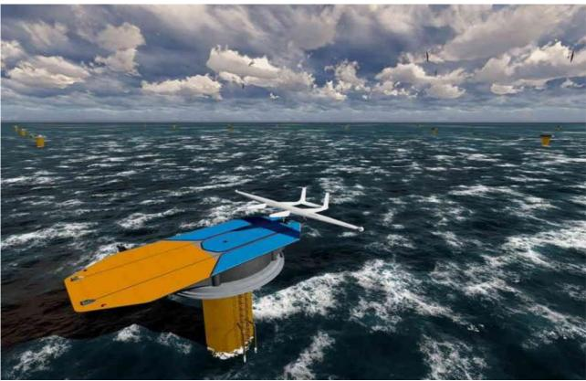
Работает система так: беспилотный самолет привязывают к основанию, а затем запускают в воздух, по принципу «воздушного змея». Летает аппарат по восьмерке на высоте 200-450 метров. Когда самолет
