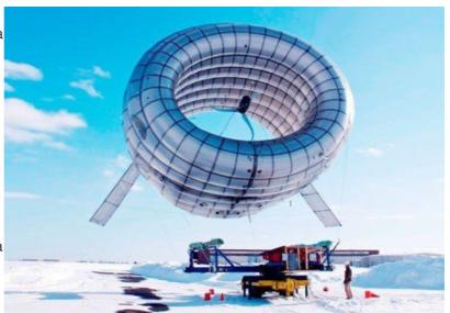
ВАТ - кольцевая оболочка, заполненная гелием. В ее центре находится турбина и электрический генератор.
