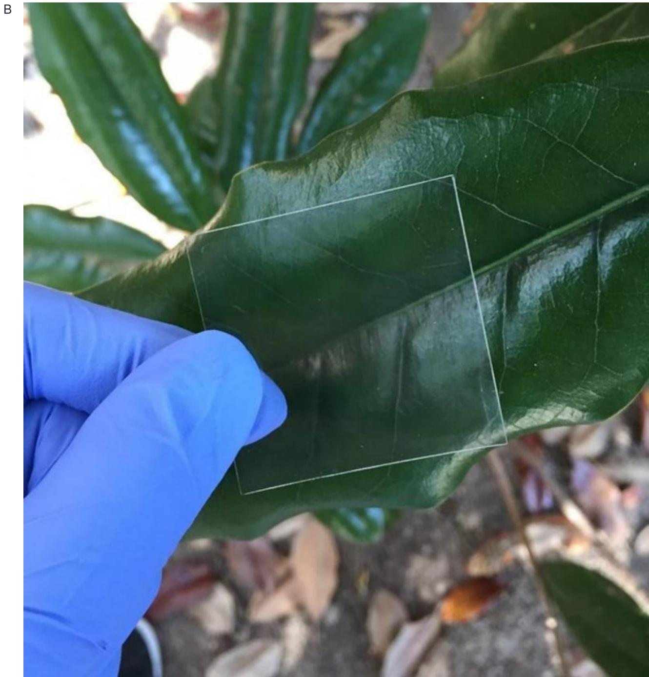
университете штата Мэриленд обычные деревянные пластины сделали прозрачными. Они пропускают несколько меньше света, чем стекло, но зато более прочные и обладают хорошими изоляционными свойствами. Возможно, перед нами прототип нового энергоэффективного строительного материала.
