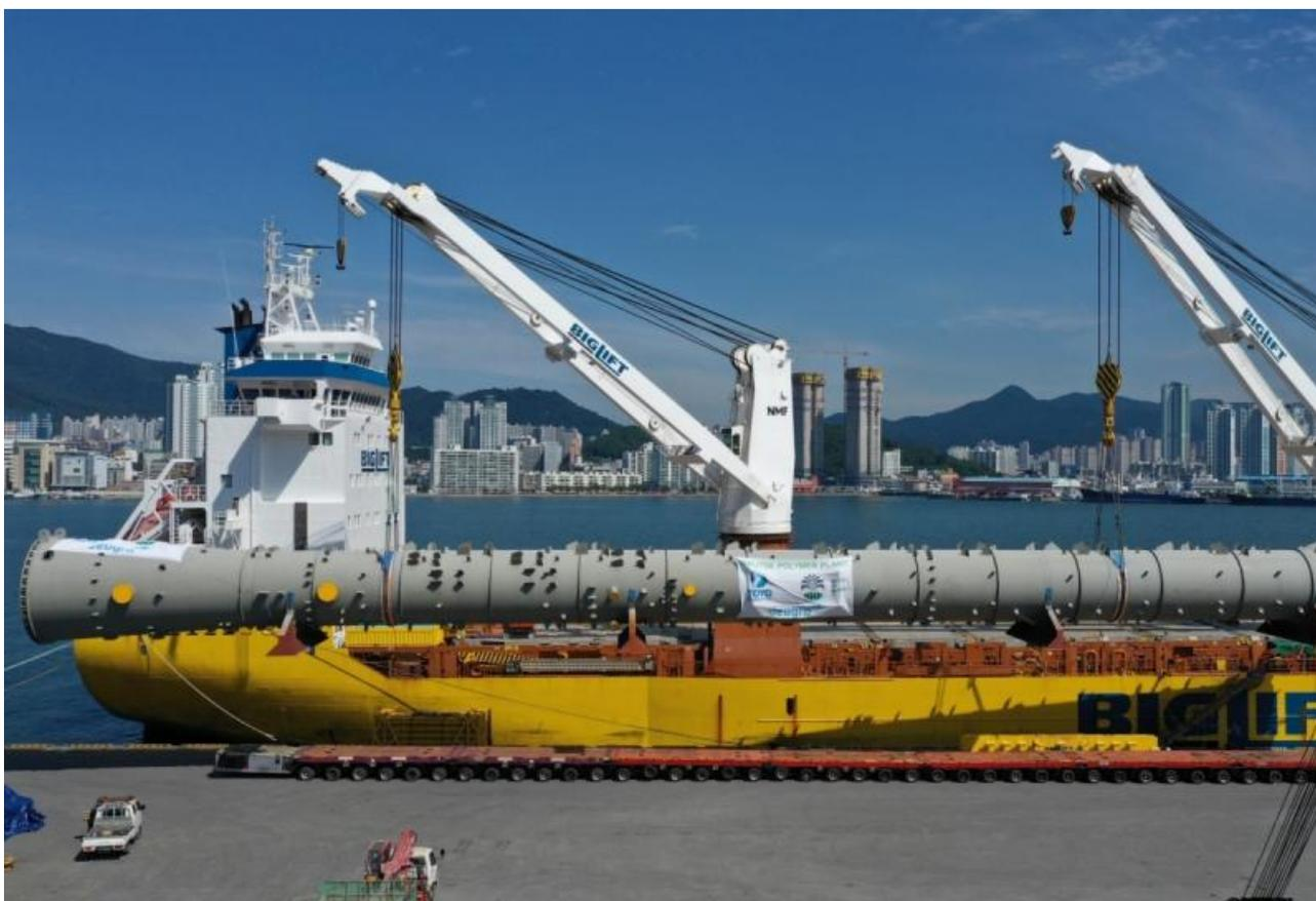
Самым большим оборудованием по размеру и весу является деэтанализатор (этиленовая колонна) – длиной 81,9 метров и весом 357 тонн, продувочный бункер продукта – 53,5 метров и почти 500 тонн, реактор полимеризации - 44,5 метров и весом 597 тонн. Оборудование произведено в Японии, Корее, Китае.
