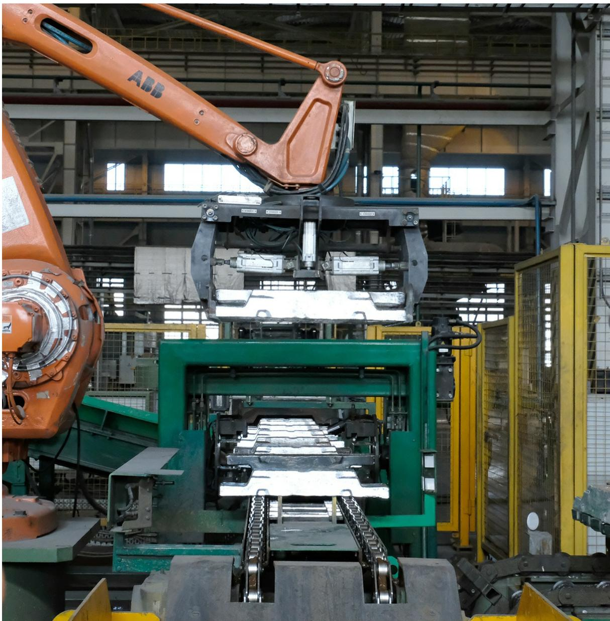
Робот, который без остановки укладывает чушки в штабеля.
