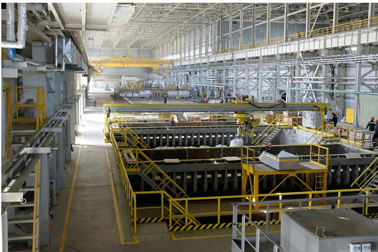
Цех по ремонту электролизеров. В электролизере глинозем подвергается воздействию электрического тока, который проходит между ванной, являющейся катодом, и специальными анодами. Это очень разрушительный процесс, который не выдерживает даже керамика.
