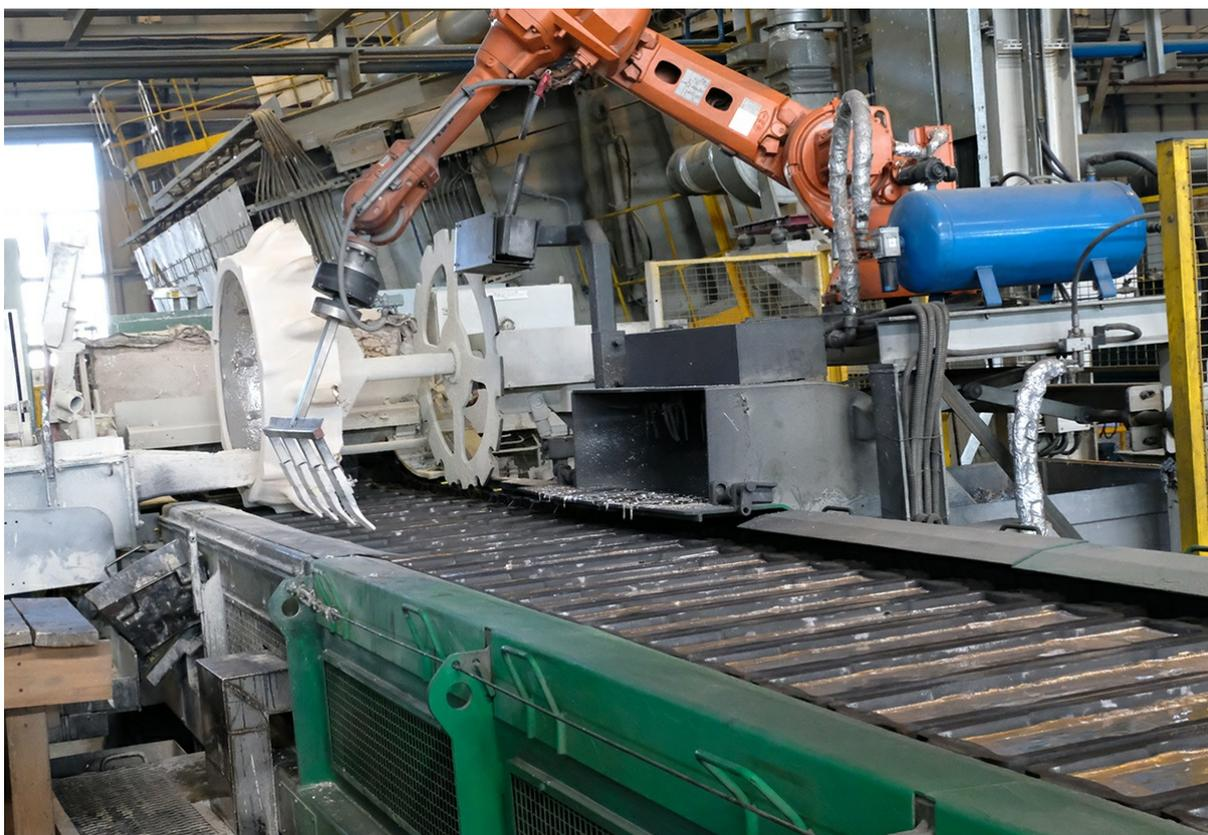
Производство полностью автоматизировано. На фото - робот, снимающий оксидную пленку. На старых заводах это делалось вручную.
