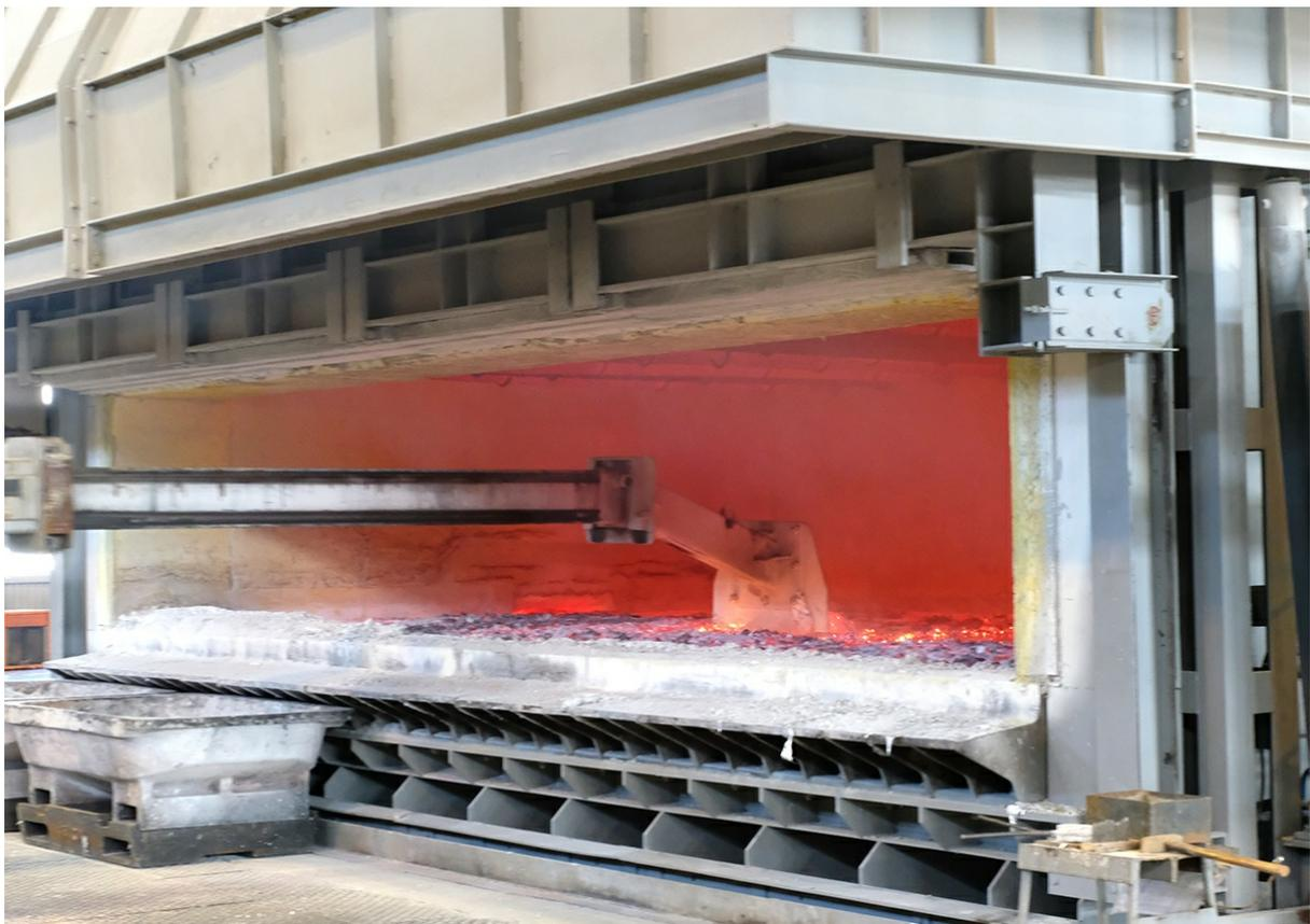
Ванна с расплавленным алюминием, в которой он перемешивается специальной машиной для удаления побочных газов.
