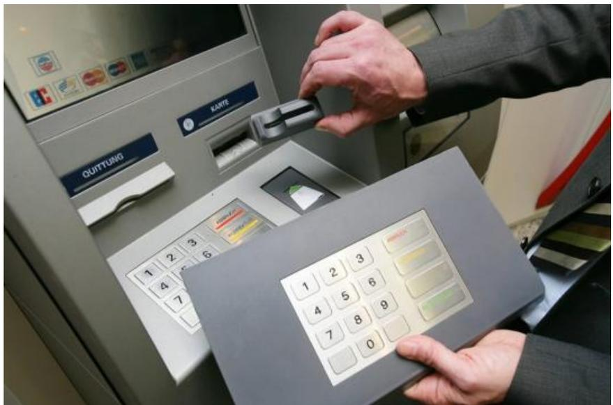
переносной скиммер, прикладывая его к терминалу.
