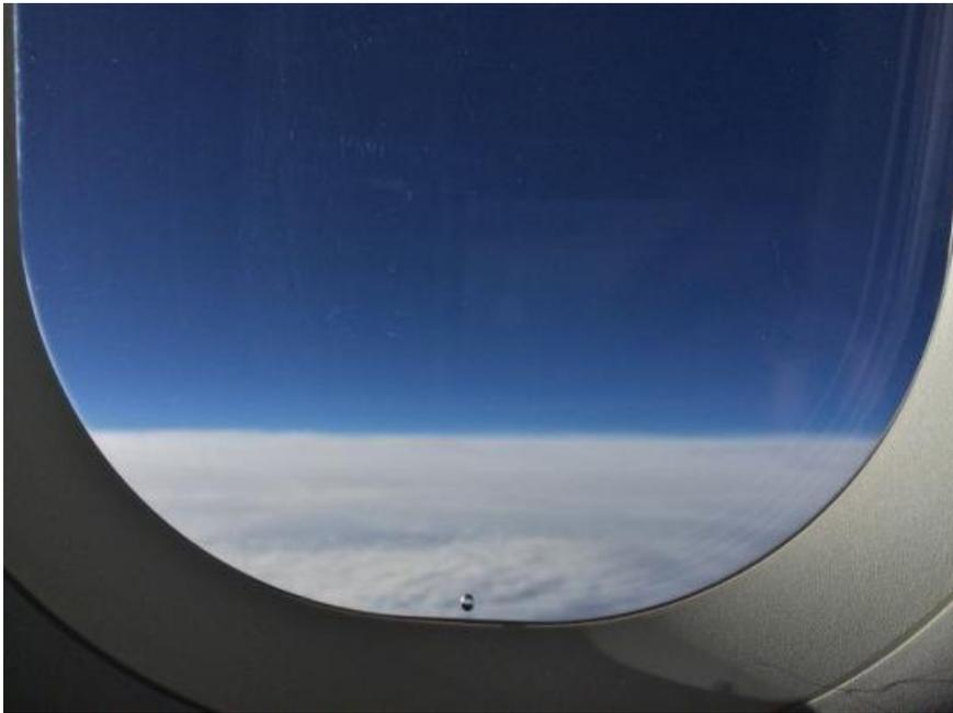
Большинство любопытных пассажиров видели небольшое круглое отверстие в иллюминаторе. Оно нужно для того, чтобы сбалансировать разницу в уровнях давления.
