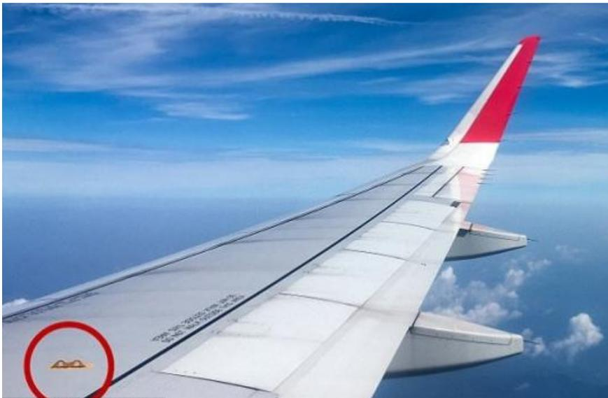
Для чего нужно крепление на крыле? В случае аварийной ситуации пассажиры должны спуститься по аварийному трапу. Для того чтобы до него добраться, надо выйти на крылья самолета. Без падений тут не обойдется – крылья скользкие от атмосферной влаги. Поэтому и было придумано специальное крепление. В него продевается веревка, один конец фиксируют у выхода, другой – у трапа, веревка натягивается. Держась за нее, как за поручень, пассажиры могут безопасно выбраться из самолета.
