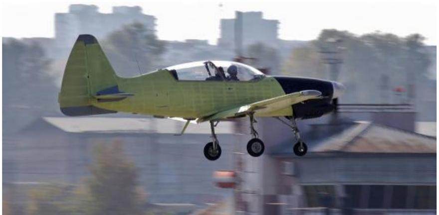
Для новинки авиастроения предусмотрена максимальная скорость горизонтального полета до 300-320 километров в час, посадочная скорость в 100-120 километров час. Потолок самолета составляет 4000 метров, максимальная дальность полета – 1400 километров.
