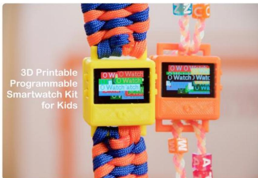
Конструктор в базовой версии состоит из микропроцессора Arduino Zero с 16-цветным OLED-экраном разрешением 96x64 пикселей, напечатанного на 3D-принтере корпуса, аккумулятора и шнурков для вязания браслета. В комплект для продвинутых производители добавят плату с компасом и тремя датчиками: влажности, температуры и давления.
