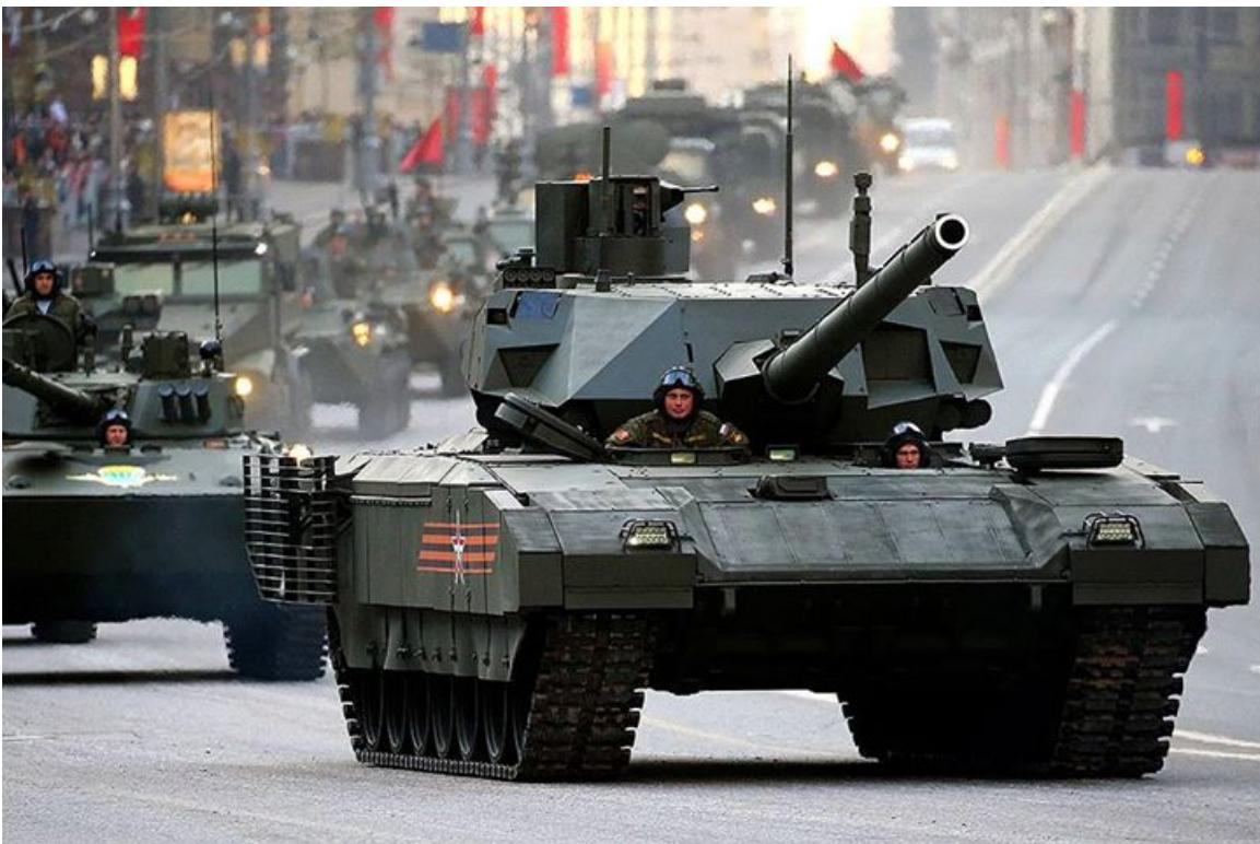
Высокая, угловатая башня непонятной конфигурации, без намека на современные углы наклона для отражения снарядов, без динамической защиты.
