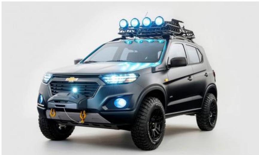
О «начинке» новинки доподлинно известно немного. Chevrolet Niva будет оснащаться бензиновым двигателем 1,8л (разработки Peugeot). Его крутящий момент на 30% больше, чем у нынешней модели. Ждать ли дизельной версии силового агрегата? Пока не стоит. Разработка дополнительного проекта трансмиссии под дизель потребует значительных инвестиций и времени, поэтому производитель отложил эту идею до лучших времен.
