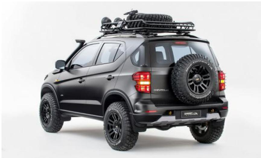
Высокий клиренс, защита двигателя и переднего моста, 16-дюймовые колеса с «зубастыми» шинами, шноркель, дополнительная светотехника на крыше и экспедиционный багажник с запасным колесом — автомобиль представлен в полном снаряжении. Именно так, судя по пресс-релизу, выглядит главная концепция Chevrolet — «Find New Roads». Там, где дорог нет, Niva их прокладывает.
