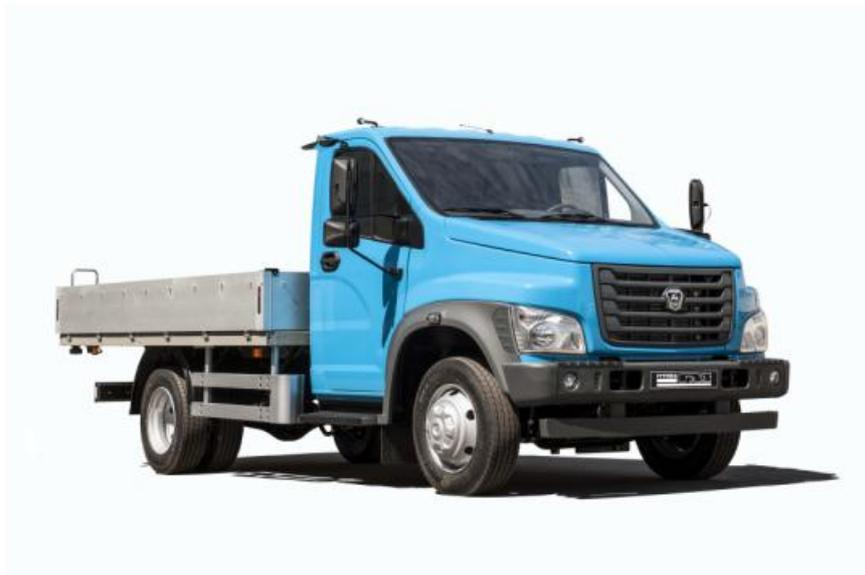
Как пишет пресс-служба «Группы ГАЗ», от продающейся сейчас модели Next новое поколение отличается повышенной грузоподъемностью (на тонну) и пассажироместимостью, увеличенным ресурсом и расширенной функциональностью. Так, площадь кузова «ГАЗона» больше на 20%, а объем (с тентом) — на 42%.
