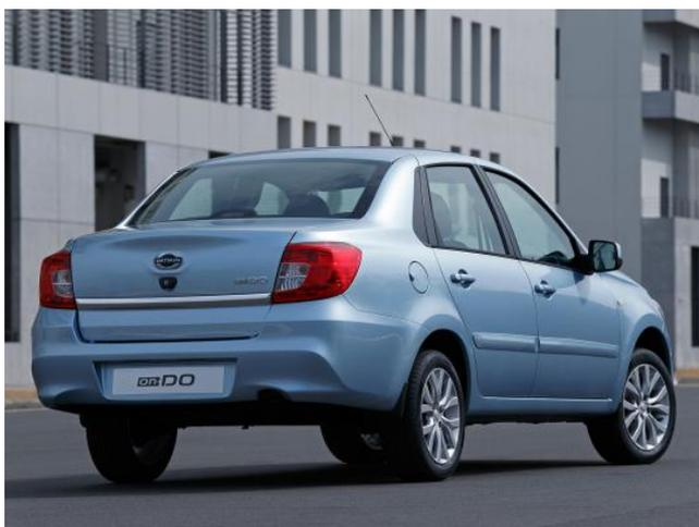
У автомобиля большой клиренс: если в машине находится один водитель, то просвет составляет 185 мм, а при полной загрузке — 168 мм. Как раз для российских дорог!
