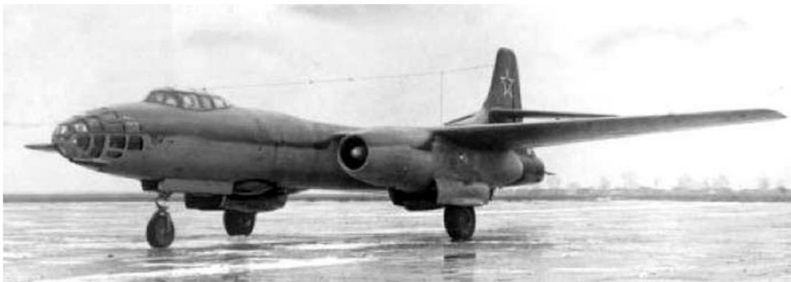
Самолёт Ту-14Т имел фюзеляж типа полумонокок, с двумя гермокабинами для экипажа и оборудования. Крылья — трапецевидные, кессонной конструкции, оснащённые четырехсекционными взлётно-посадочными щитками. Шасси трехточечное с убирающимся назад по полёту колёсами и дополнительной хвостовой предохранительной опорой.
