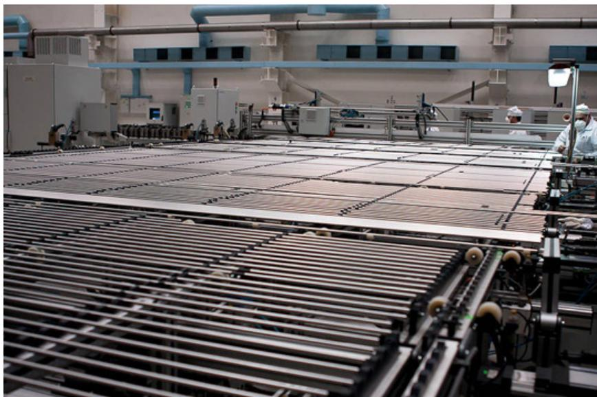
После снаряжения цилиндра начинается его проверка, каждый стержень проверяют на кучу параметров (качество сварки, царапины, устойчивость к сгибанию, отклонение диаметров и т.п.).
