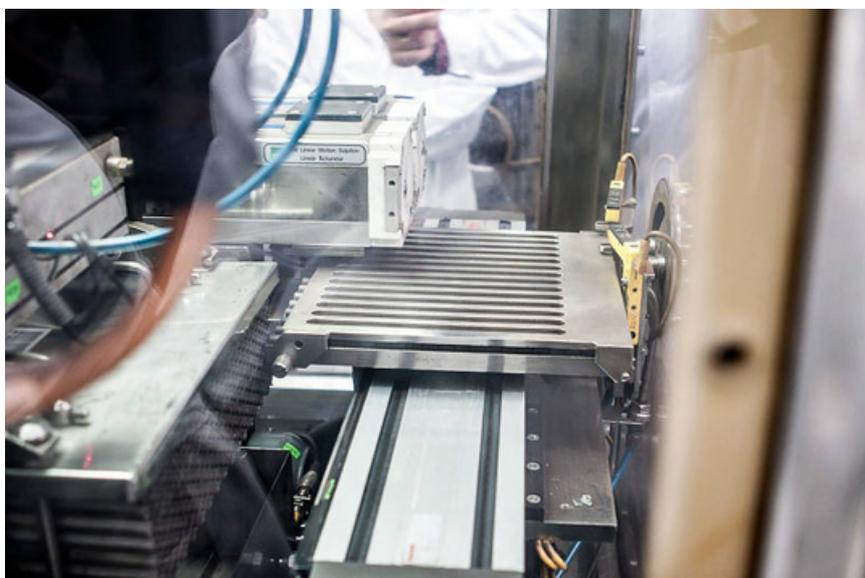
Потом устанавливают в него пружину (она будет удерживать таблетки), откачивают воздух, закачивают газ гелий и запаивают со второго конца.
