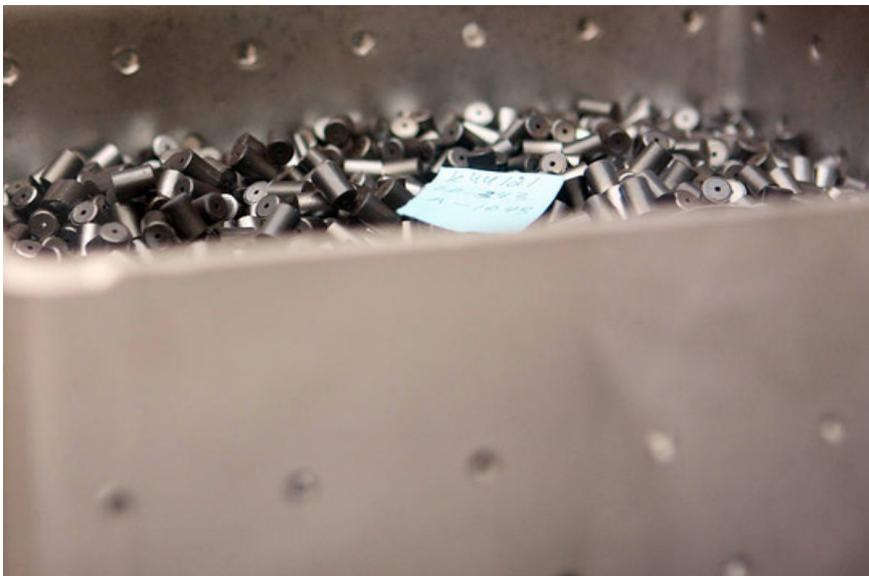
Теперь каждую таблетку визуально осмотрит девушка на предмет деформации, трещин, сколов. По словам начальника цеха в Новосибирском академгородке уже разрабатывается прибор для автоматического
