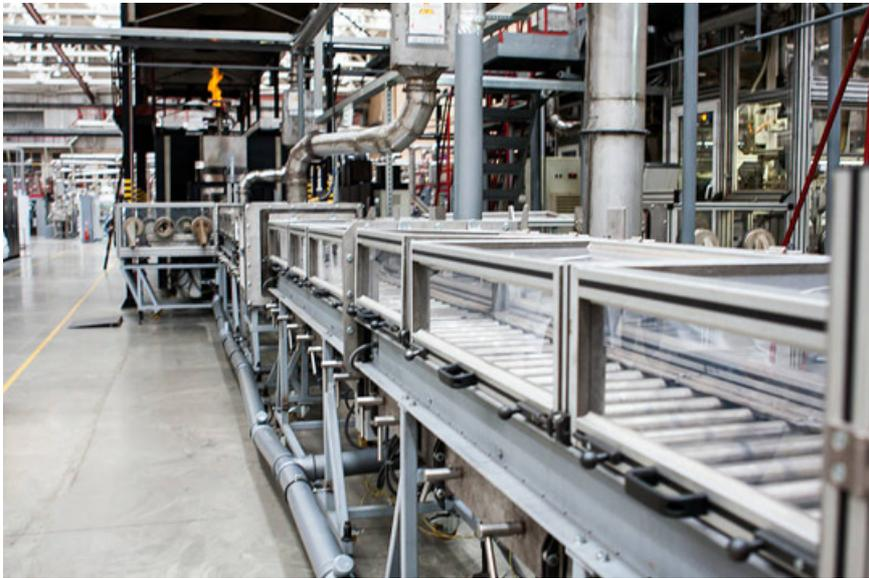
Печь импортного производства так же позволяет исключить человека в процессе запекания таблетки. Запекание происходит за несколько этапов, на предварительном нагреве выгорают добавки, потом происходит запекание таблетки и охлаждение.
