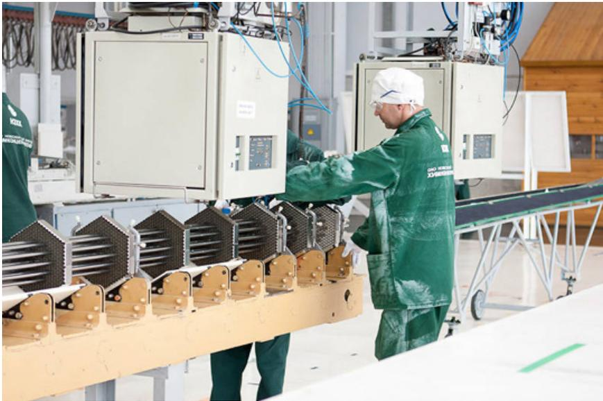
Теперь автомат заполнит ТВС топливными стержнями, всего необходимо установить 312 стержней.
