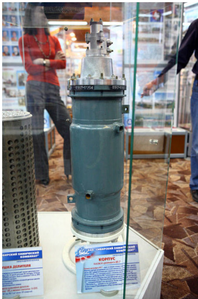
А вот ещё одна особо секретная вещь – газовая центрифуга по разделению изотопов (урана 235 от урана 238).
