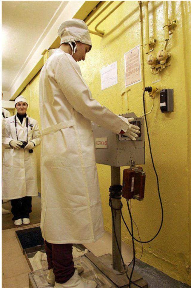
При выходе из "грязных" помещений все подвергаются проверки на специальных аппаратах.
