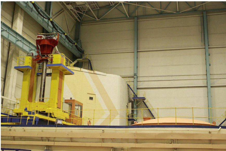
Сборки поднимают из реактора и опускают обратно с помощью этой штуковины.
