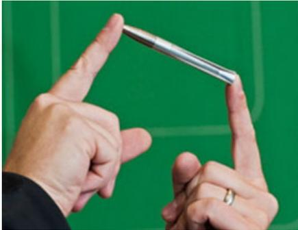
Это позволяет смертоносному кусочку стали "видеть" лазер, который направлен на цель. А успешно добраться до нее изрядно "поумневшей" пуле помогают крошечные моторы, управляющие микро рулями, которые меняют направление полета.
